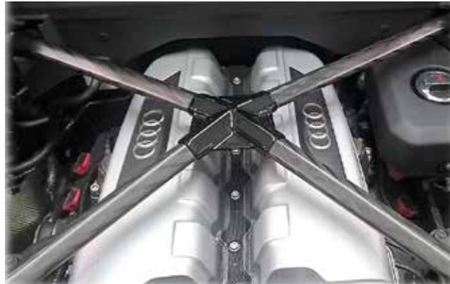
Bild 6. CFK-Strebenkreuz in One-Shot-Technologie: Audi entwickelt hochbelastbare CFK-Automobilkomponenten mittels einer Kombination von Pultrusions- und Fließpressverfahren (© Audi AG)
