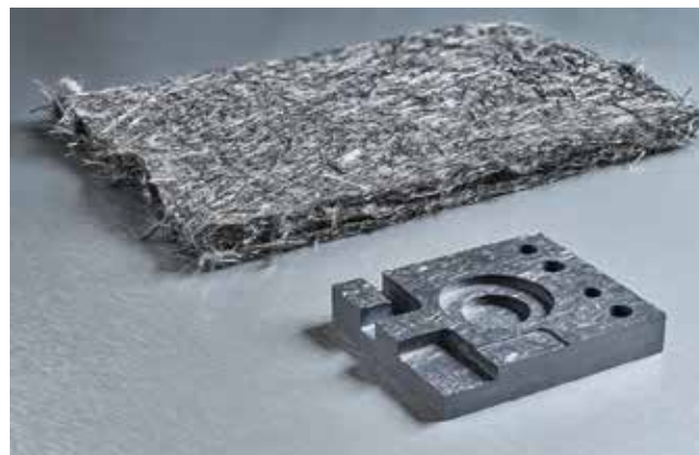
Bild 4. Das Recycling-SMC rCF 40NC Epoxy ist ein nachhaltiger Metalleersatz für bewegte Massen im Maschinenbau und zeichnet sich durch gute Fräsbarkeit aus
