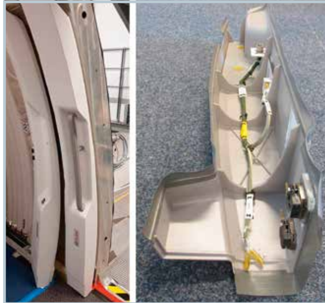
Bild 5. Demonstrator einer Türrahmenverkleidung: Das vom CTC Stade und Partnern entwickelte Hybrid-SMC mit fließfähigen SMC-Außenschichten und versteifenden, vorimprägnierten Endlosfaserverstärkungen ermöglicht komplexe Luftfahrtbauteile (© CTC GmbH)
