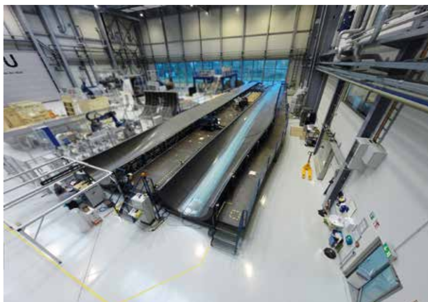
Bild 5. Schnelle Fasertränkung sowie Bauteilrobustheit prägen die Holmfertigung mit Baydur-Polyurethan von Covestro und Saertex-Glasfasergelege (© Duplexmedia)
