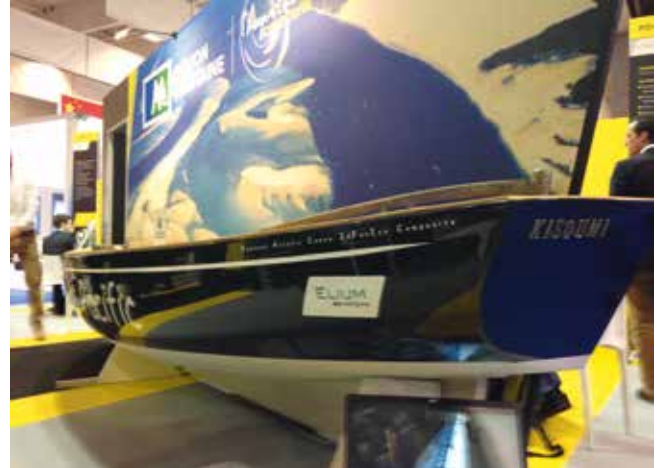
Bild 3. In-Situ-Acrylat macht Infusion bei Raumtemperatur möglich und führt zu schadenstoleranten Bauteilen: CFK-Boot mit thermoplastischer Matrix (Bild: Arkema/Canoe)
