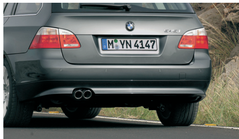
Bild 2. Thermoplastische Polyolefine mit elastomerem Modifikator für integrierte Front- und Heckstoßfänger der neuen BMW 5er- und 6er-Reihe erfüllen dank guter Verarbeitbarkeit hohe Design- und Funktionsanforderungen und sorgen für hohe Kälteschlagzähigkeit
