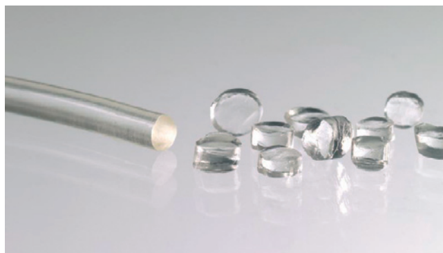
Bild 7. Das thermoplastisch verarbeitbare Polymethylsiloxan-Harnstoff-Copolymer besitzt ein wärmebeständiges, thermoplastisches Hartsegment sowie eine Weichphase auf Silikonbasis, die für hohe Elastizität, gute Trenn- und Gleiteigenschaften sowie hervorragendes Tieftemperaturverhalten sorgt (Foto: Wacker-Chemie)
