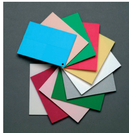
Bild 4. Helle Farbtöne und Pastelltöne bei niedrigem Gelbstichindex und guten mechanischen Eigenschaften ermöglichen neue TPE-V-Typen (Foto: Solvay Advanced Polymers)
