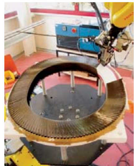
Bild 3. Effiziente Preform- und Handlingtechniken. Links: geflochtenes Preform für den im Infusionsverfahren gefertigten Stoßfängerträger des BMW M6 (Foto: F. A. Kümper), Mitte: drapierfähige Binderfaser mit schmelz- und härtbarer Epoxydharzbeschichtung für stabile Vorformlinge variabler Geometrie (Foto: Toho Tenax), Rechts: In der Dry Fibre Placement Technology entnehmen Roboter ungetränkte Fasern oder UD-Tapes und konfektionieren sie zum Preform (Foto: Hexcel, Lyon/Frankreich)
