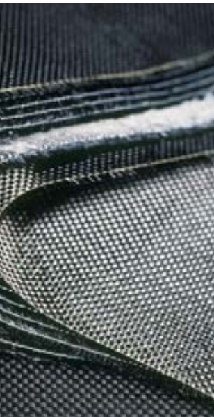
Bild 5. Lagenaufbau der Kunststofffaserverstärkung für das Dach des BMW M3 CSL (Foto: BMW)
