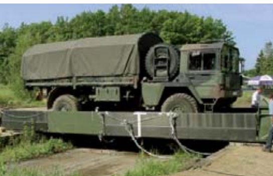
Bild 7. Modulare 4-Feld-Pionierbrücke aus CFK (Foto: WTD 51, Koblenz)
