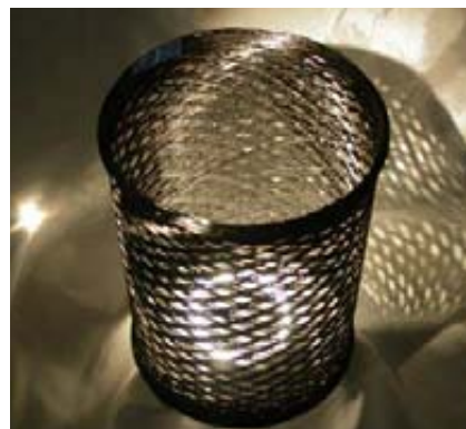
Bild 3. Effiziente Preform- und Handlingtechniken. Links: geflochtenes Preform für den im Infusionsverfahren gefertigten Stoßfängerträger des BMW M6 (Foto: F. A. Kümper), Mitte: drapierfähige Binderfaser mit schmelz- und härtbarer Epoxydharzbeschichtung für stabile Vorformlinge variabler Geometrie (Foto: Toho Tenax), Rechts: In der Dry Fibre Placement Technology entnehmen Roboter ungetränkte Fasern oder UD-Tapes und konfektionieren sie zum Preform (Foto: Hexcel, Lyon/Frankreich)
