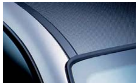
Dachausschnitt des BMW M3 CSL aus kohlenstofffaserverstärktem Kunststoff (Foto: BMW)
