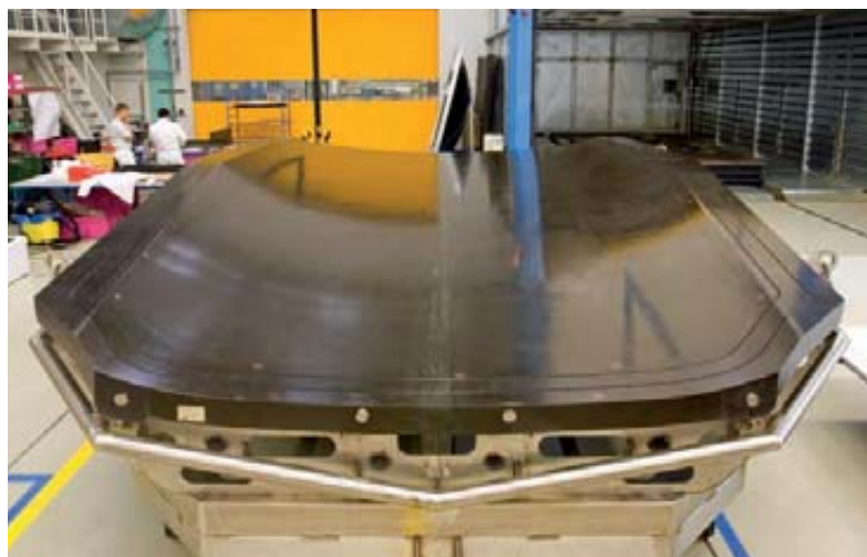
Bild 4. Das Frachttor des Militärtransporters A 400M wird komplett in CFK gebaut. Auch die Torsionsbox und alle Rippen entstehen aus dem gleichen Material (links: Designstudie; rechts: erstes Tooling für die Außenhaut) (Foto: EADS)
