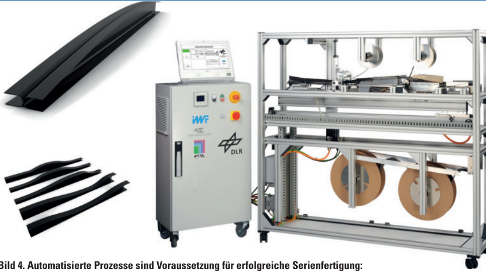
Bild 4. Automatisierte Prozesse sind Voraussetzung für erfolgreiche Serienfertigung: Kontinuierliche Herstellung von CFK-Profilen mit variablem Querschnitt (Foto: DLR)
