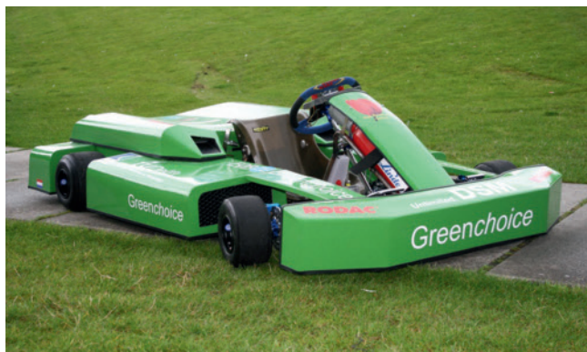
Bild 5. Biobasiertes und mit Flachfasern verstärktes Harz für ein wasserstoffbetriebenes Kart (Foto: DSM/TU Delft)
