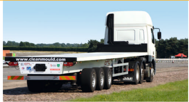
Bild 4. Lkw-Sattelaufleger aus thermoplastischem Verbundwerkstoff auf Basis von cycloaliphatischem Butylenterephthalat (CBT) (Foto: IKV Aachen)
