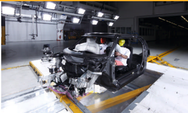
Bild 2. Erprobungsträger mit CFK-Fahrgastzelle (Foto: BMW)
